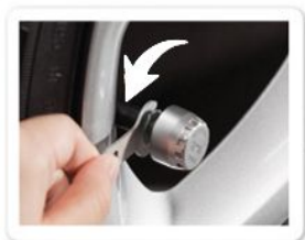
4 用螺母扳手反向逼紧传感器
