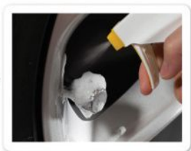
5 用肥皂水检查是否漏气
